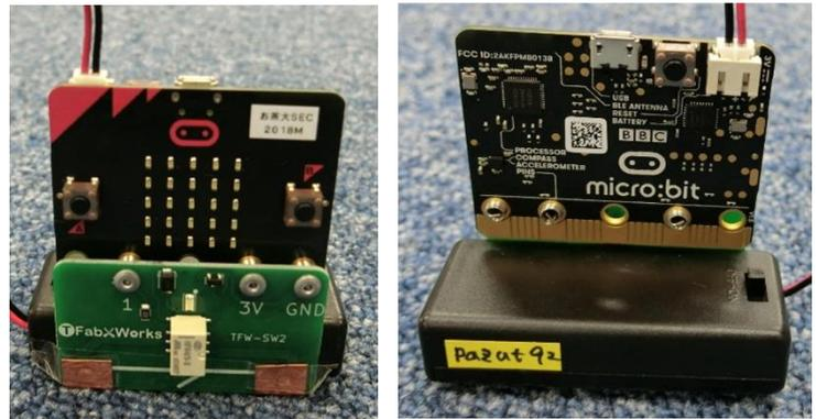
図2 電池ボックスをつけたmicro:bit (左 表面、右 裏面)
