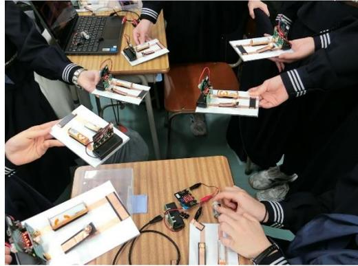
図11 実践のようす 右下の生徒が自分のモーターに負荷をかけると、他6名の生徒の手元の豆電球が点灯する仕組みをつくった。
