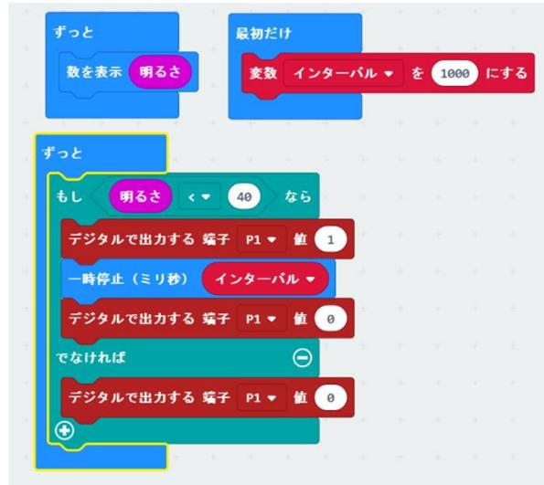
車に勢いがついてうまく止まれない場合のコードの改良例。電流 ON/OFF を短い時間で繰り返し、少しずつ車を進ませるように工夫している。
