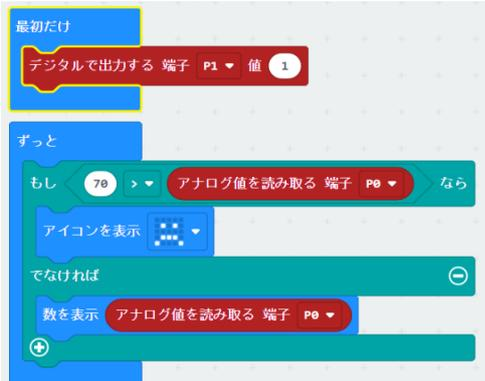
電圧の数値を区切り、段階的に表示を変えることで、モーターに加わる負荷に応じて表示を変えることが可能である。
