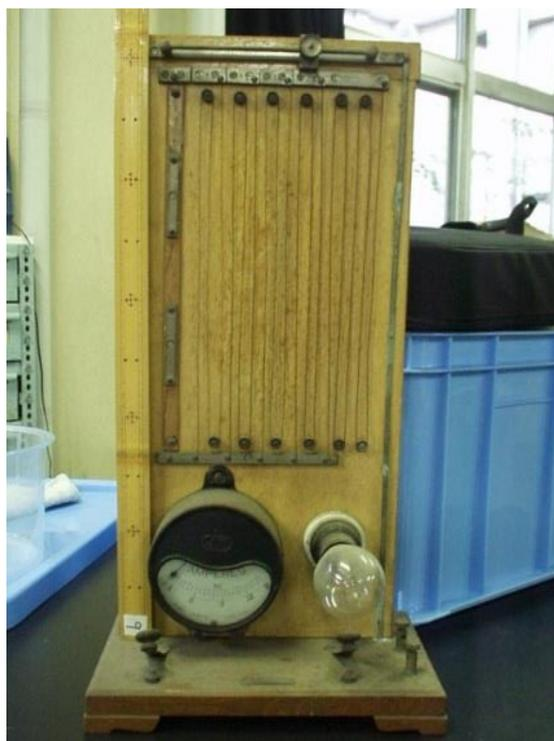
図36 テイエス電流、抵抗、電熱実験器
