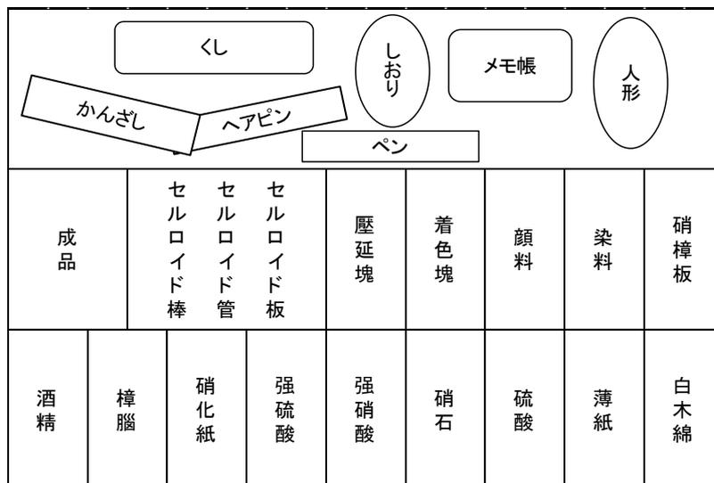
図9 図8の原材料、中間品、製品の配置
