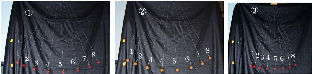
図4 ②は①の振り子の重さを変えた時の記録、③は①の振り子の振れ幅を変えた時の記録である。ストロボスコープはいずれも1000rpmで撮影している。振り子が端から端まで振れる時間は変わらないことがわかる。
