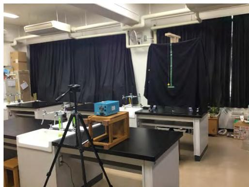
図 1 実践を行った時の理科室のようす。奥に振り子が，手前にストロボスコープと三脚に設置したカメラがある。
