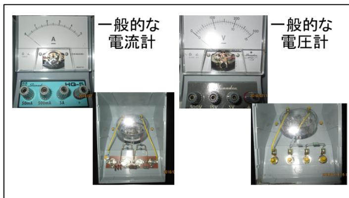
図3 一般的な電流計・電圧計と内部構造
