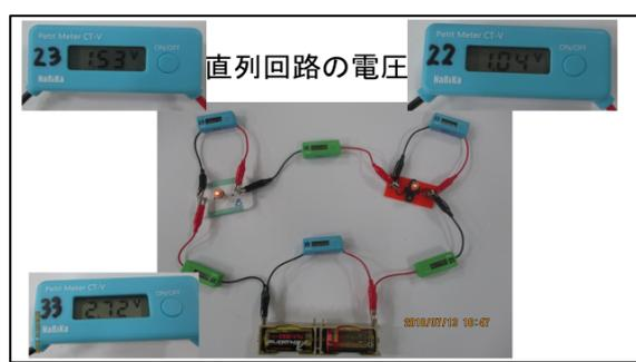
図7 デジタル電圧計と直列回路
