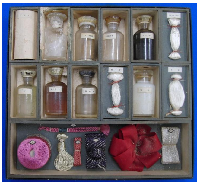
図 13 人造絹糸製造順序及製品標本
